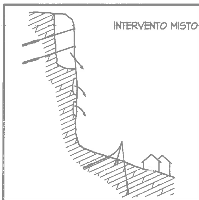
Fig. 10 - Intervento di tipo misto: attivo (in parete) e passivo (barriera paramassi)
